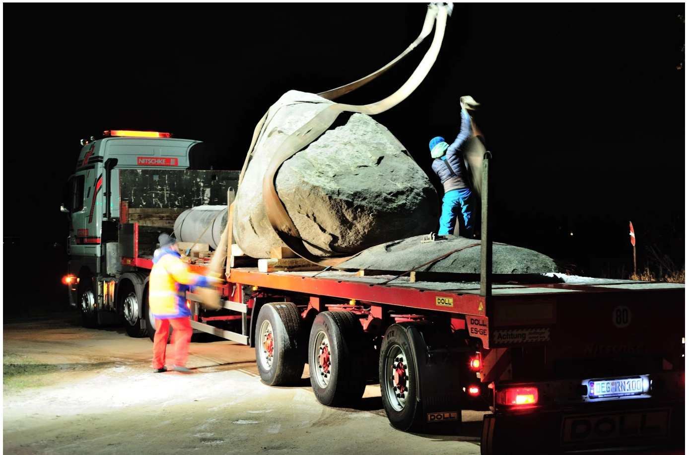
Ohne Autokran geht beim Transport gar nichts. 22 Tonnen wiegen der Monolith und der Bohrkern zusammen. Foto: Martin Kreuls
