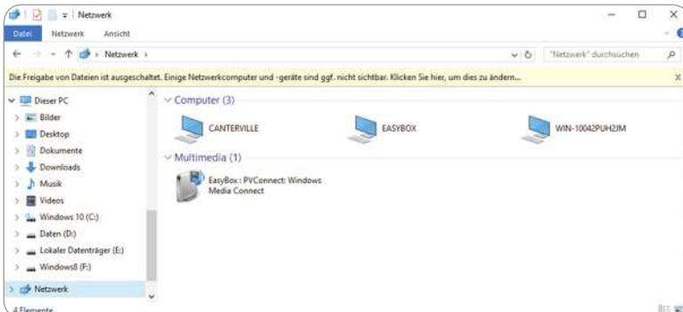
Bild 8.21: Meldung bei ausgeschalteter Netzwerkerkennung und Dateifreigabe.
