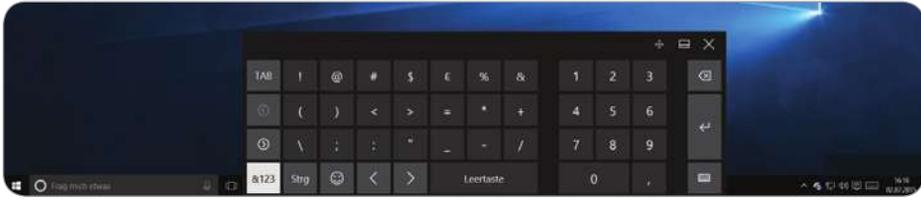
**Bild 3.24:** Ein Klick auf die Taste `[123]` unten links schaltet auf ein Tastaturlayout mit Ziffern und Sonderzeichen um.
