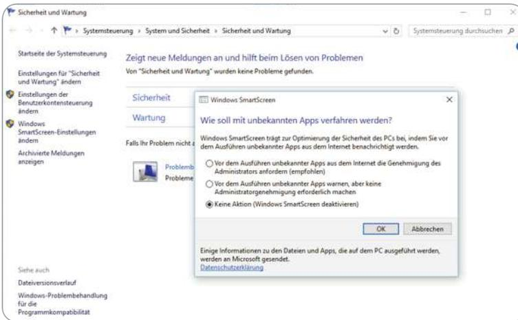
**Bild 9.42:** Den Windows SmartScreen-Filter für heruntergeladene Programme abschalten.
