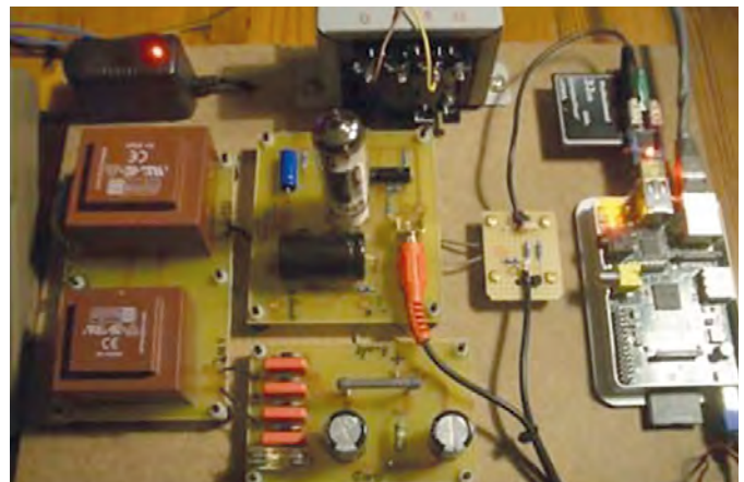
Verbaut wurde ein Röhrenverstärker mit 4 Watt Sinusleistung
