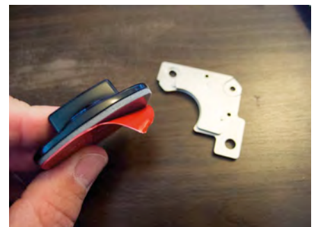
6 Magnet und Kamerahalter zusammenbringen, Teil 1
