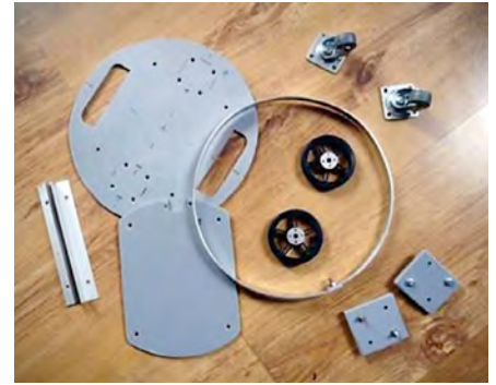
Der Rundrahmen muss sehr genau gefertigt sein
