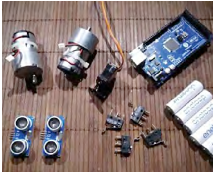
Die Bauteile des Robots für Sensorik und Antrieb
