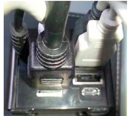
Alle Anschlüsse an einer Gehäusewand: Um einen Stecker zu ziehen, müssen oft auch Nachbarstecker entfernt werden.
