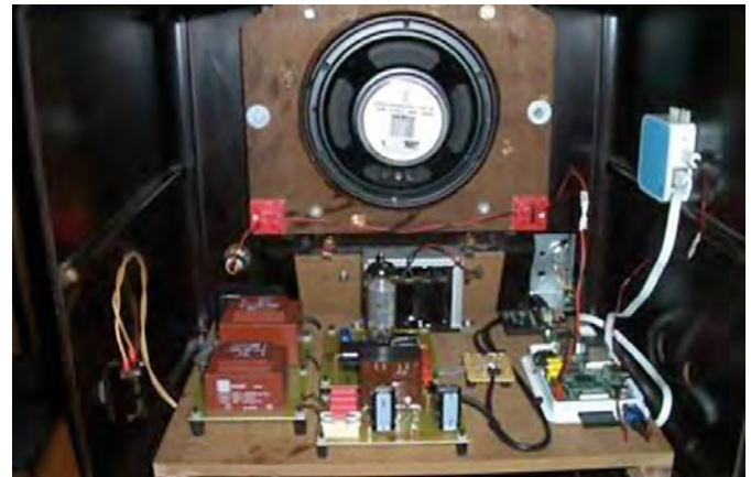
Ein kleiner WLAN-Hotspot (blau, rechts) spannt ein autarkes WLAN auf.
