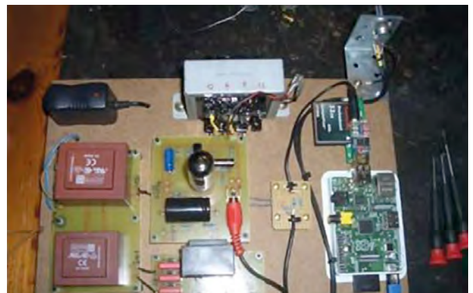
...wird gefüllt mit neuer Technik: rechts der Raspberry Pi vom Typ 1
