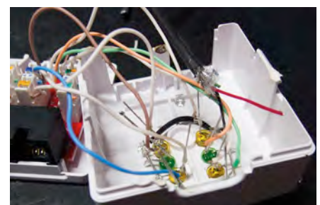
7 Lose Kabelenden verlöten
