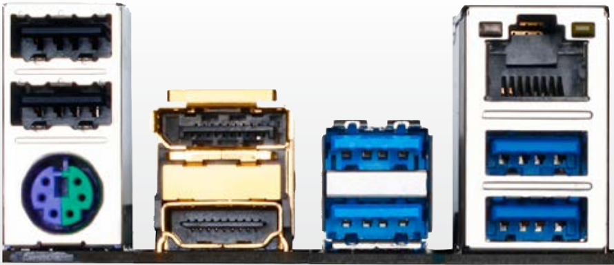
Links über dem grün-lilafarbenen PS/2-Port sind die zwei schwarzen USB-2.0-Anschlüsse zu sehen. Rechts sind die USB-Ports nach dem 3.0-Standard in blau vorhanden. Je nach Mainboard gibt es mehr oder weniger 3er-USB-Ports.
