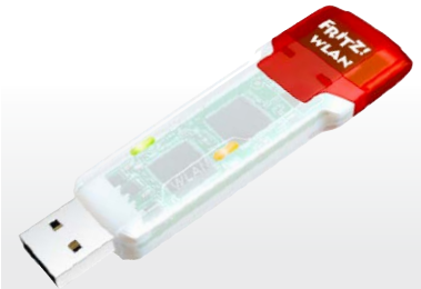
Einfaches Upgrade: Ein Dual-Band-USB-Adapter wie der Fritz WLAN Stick N verleiht dank 5 GHz einem Notebook Flügel im Funknetzwerk.
