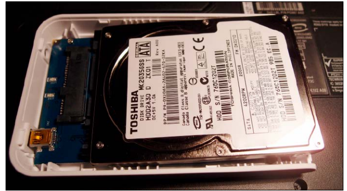
Mit einem Gehäuse machen Sie aus der alten internen 2,5-Zoll-Festplatte Ihres Notebooks im Handumdrehen einen externen Datenträger.
