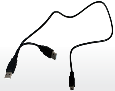
Y-USB-Kabel sieht die USB-Norm eigentlich gar nicht vor, doch solche Kabel helfen in der Praxis bei besonders stromhungrigen Peripheriegeräten.
