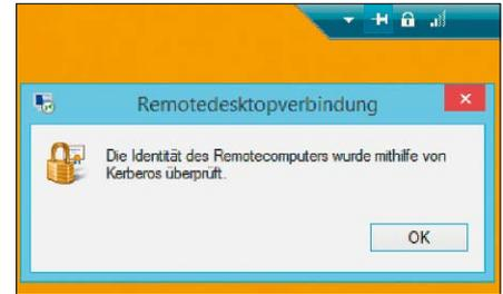
Das Symbol mit dem Vorhängeschloss zeigt, dass die Authentifizierung über Kerberos erfolgt ist.
