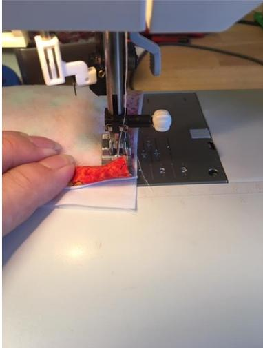
Wir ändern nach dem erfassen des Gummis wieder auf die normale Stichlänge, nähen bis zur Ecke und drehen weiter.
